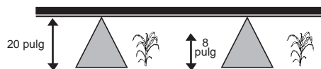
Diagrama 1: Patrón de pulverización de una boquilla de dispersión uniforme para aplicación entre hileras.
